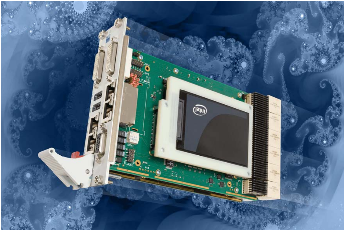
PCJ-JAM on CCM-BOOGIE, with C42-SATA SSD
